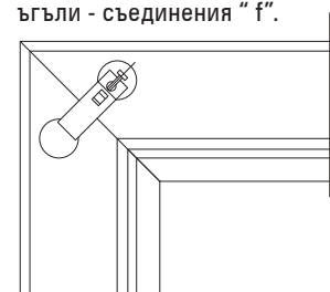
Начин на монтаж на гредата от прозорче, конфирмати "h"
